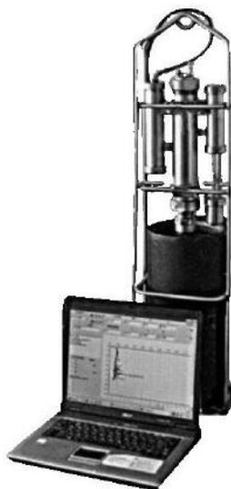
**Рис. 1.** Гидробиофизический зонд «Сальпа М»
