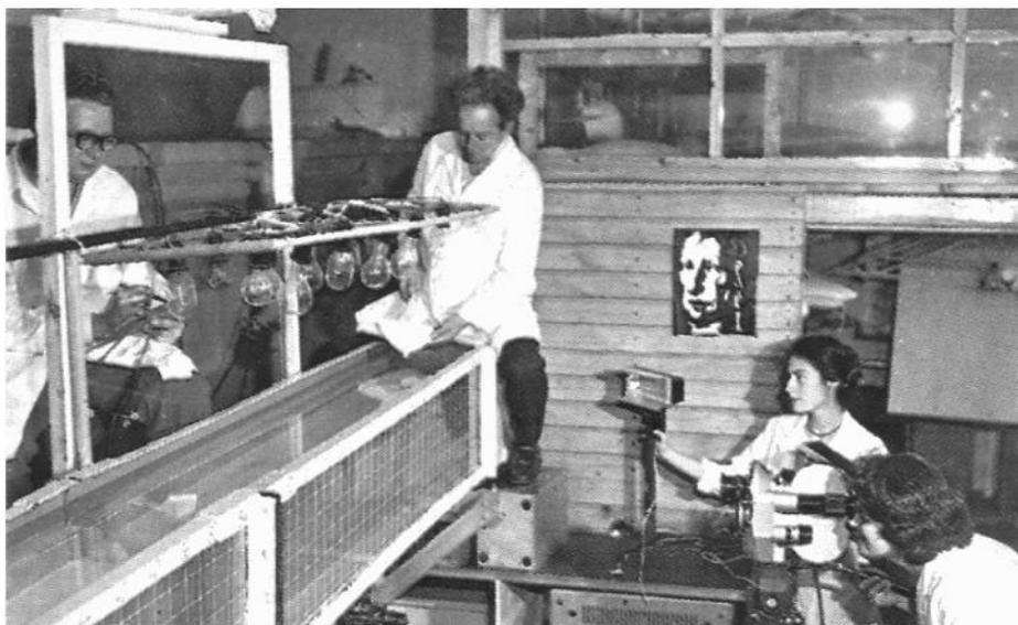
**Рис. 3.** Экспериментальные исследования по гидродинамике вымерших гетеростраков в малом био-гидродинамическом канале
