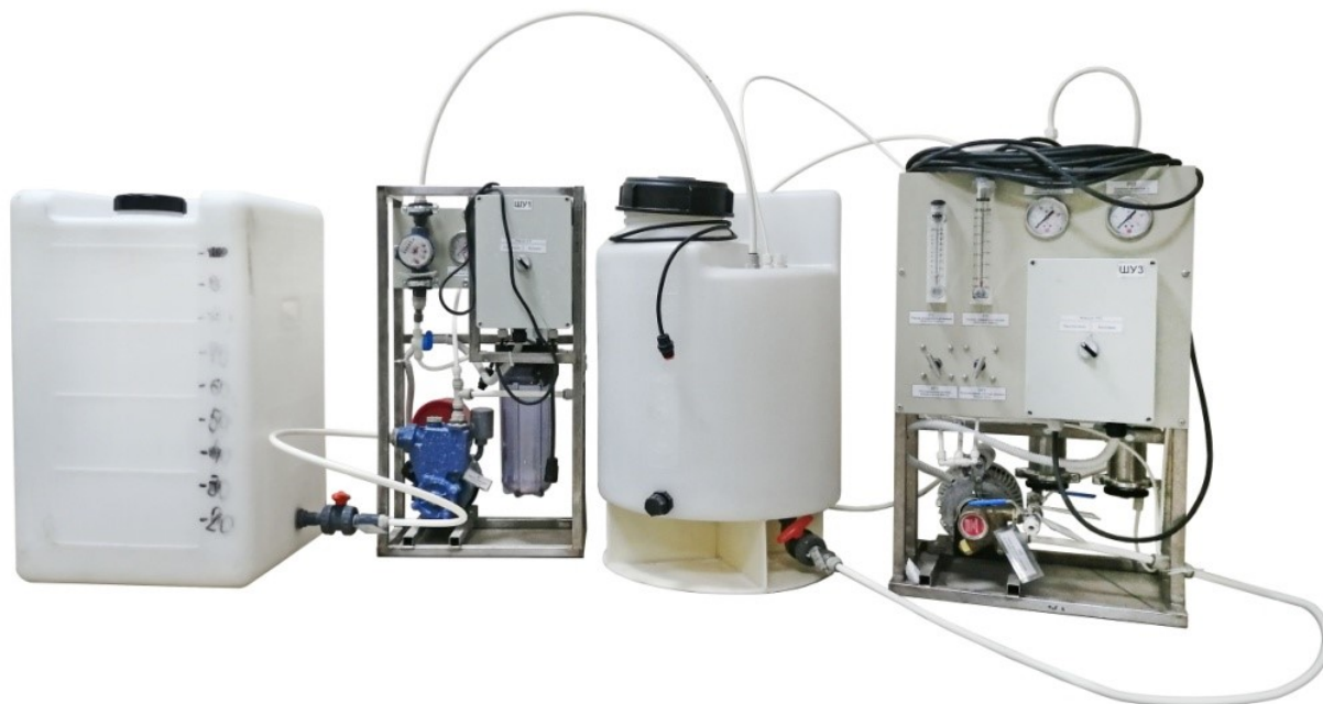
Рис. 3. Вид модулей мобильной установки для концентрирования проб воды
