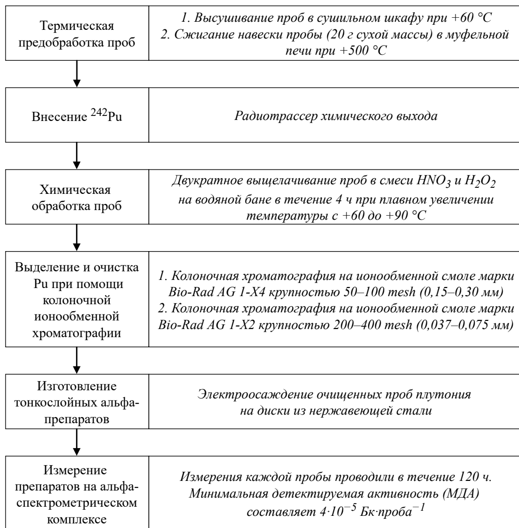
Рис. 2. Схема основных этапов определения альфа-радиоизотопов плутония в донных отложениях (Радиоэкологический отклик, 2008 ; Tereshchenko et al., 2018)
